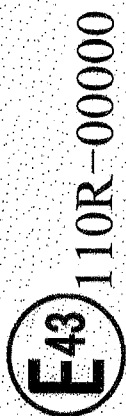
図2. 協定期則第110号に適合する記号の例(円の中の数字は国毎に定める固有の番号、円に続く数字は110、続く数字等は認可番号等)
